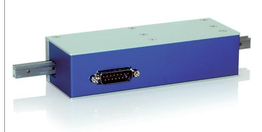
Der Linearaktor V-273 mit Voice-Coil Magnetantrieb bietet hohe Dynamik und hohe Geschwindigkeiten zu einem günstigen Preis und eignet sich für Anwendungen in der Automatisierung und Handhabungstechnik. Er erreicht Stellwege bis 20 mm und eine Geschwindigkeit bis 250 mm/s. Die Positionsmessung übernimmt ein optischer Linearencoder mit 0,1 µm Auflösung. Optional kann der Linearaktor auch mit einem Kraftsensor ausgestattet werden, der das Aufbringen definierter Kräfte ermöglicht.
