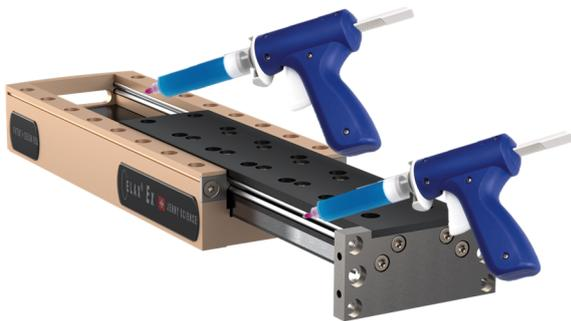
Vor dem Schmieren die Führungen reinigen. Die Nachschmierung erfolgt mit einer Dosierpistole und einer passenden Fettpatrone. Positioniere den Schlitten so um dabei jeweils an die Führungsstäbe am Schlitten und an die des Monoblocks, links und rechts zu gelangen. Verteile nun etwas Fett durch Betätigen der Dosierpistole auf die flache Lauffläche der Führungsschienen. Danach den Schlitten vor und zurück bewegen und das überschüssige Fett mit einem Wattestäbchen entfernen.
