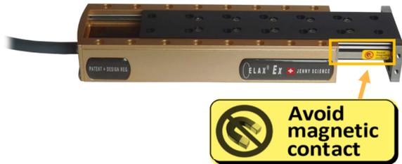
Das magnetische Messsystem ist empfindlich gegenüber magnetischen Fremdeinflüssen und kann bei unsachgemäßer Handhabung beschädigt werden. Vermeiden Sie unbedingt den Kontakt von Magnetfeldern – beispielsweise durch andere Motoren oder magnetische Arbeitsleuchten – mit dem Magnetmaßband an der Achse.
